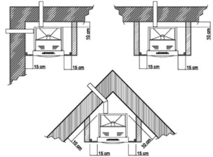
Connecter le conduit de fumées du poêle à une chemine préexistante, ou à l'extérieur de l'édifice. Installer un tuyau pour l'évacuation des fumées d'un diamètre minimal de 80 mm, jusqu'à la couverture du toit.
