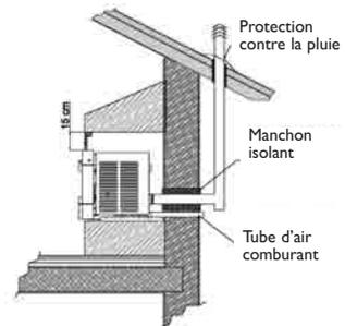
Si le poêle est installé dans un édifice aux parois inflammables, il est nécessaire de prévoir un manchon isolant entre la paroi et le tuyau d'évacuation des fumées ainsi que pour la hauteur dépassant du toit de l'édifice.
