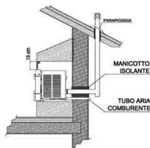
Qualora la stufa venga installata su un edificio con pareti potenzialmente infiammabili, si rende necessaria l'interposizione tra la parete ed il tubo di scarico dei fumi, un manicotto isolante, così anche per quanto riguarda lo sbalzo del tetto dell'edificio.
