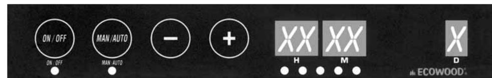
La regolazione dell'orologio e la programmazione dei cicli di accensione e spegnimento automatico della stufa devono essere effettuate con il fuoco spento.
